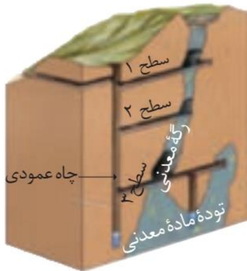
شکل ۸-۲: نحوه بهره برداری از معادن زیرزمینی
